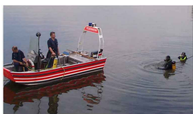
Das Boot entspricht den Typ RTB 2 nach DIN 14961 (Boote für die Feuerwehr) in der aktuellen Fassung.
