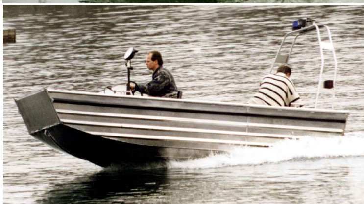
Das Boot entspricht den Typ RTB 2 nach DIN 14961 (Boote für die Feuerwehr) in der aktuellen Fassung.
